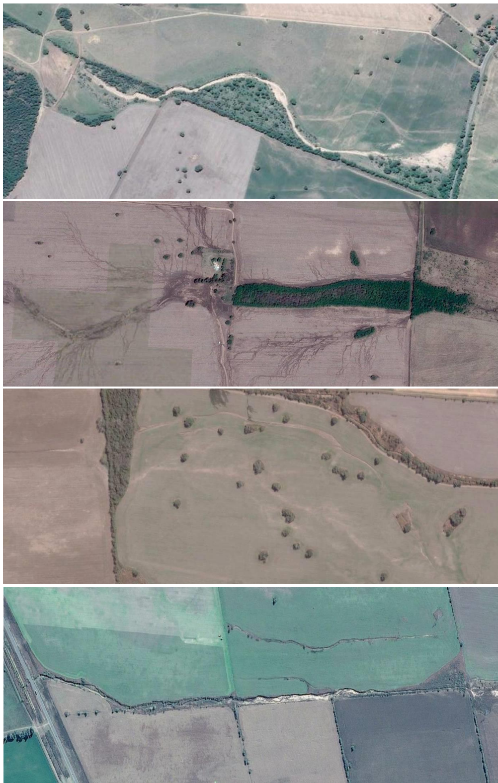
Figura 24. Áreas pedemontanas. Erosión hídrica acelerada en forma laminar, en surcos y cárcavas. De arriba abajo: cuencas de los ríos Guanusacate, Mula Muerta, Pinto y Los Mistoles.
