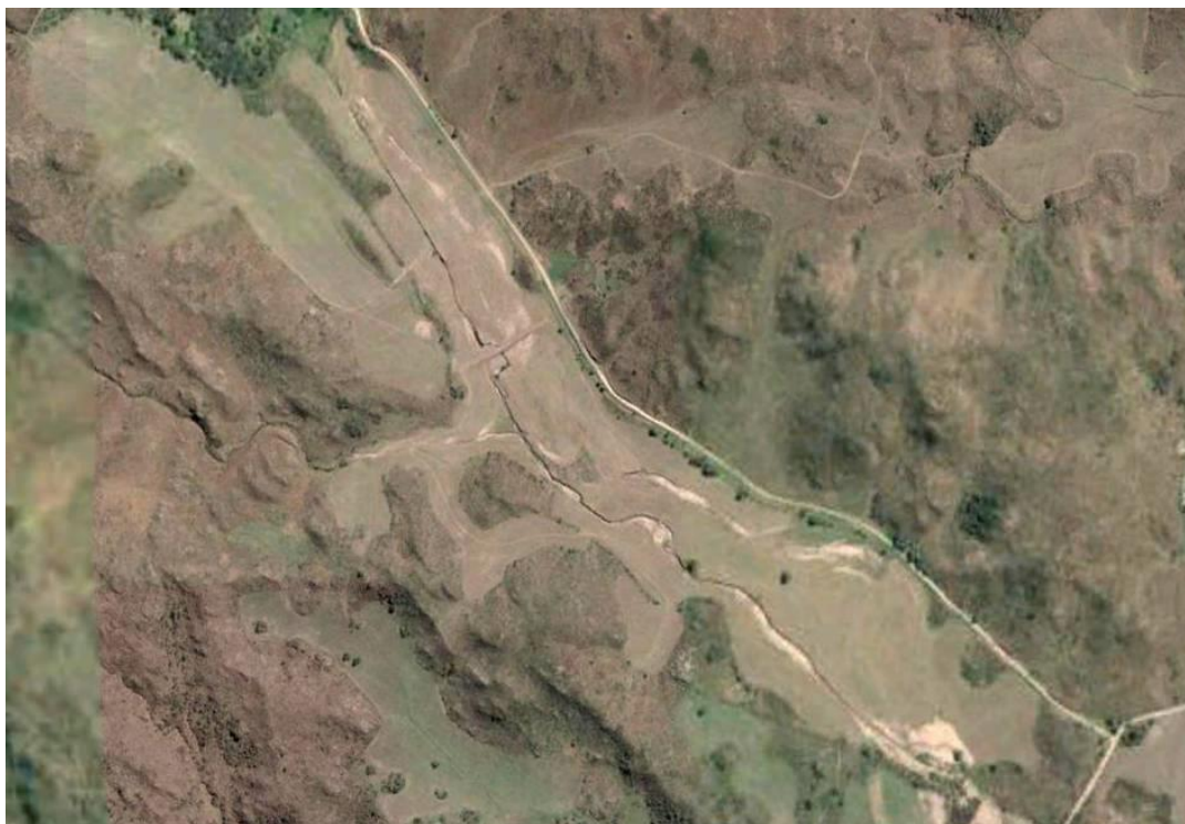
Figura 18. Erosión hídrica concentrada en cárcavas en valles estructurales plano-cóncavos secundarios. Cuenca R. Guanusacate.
