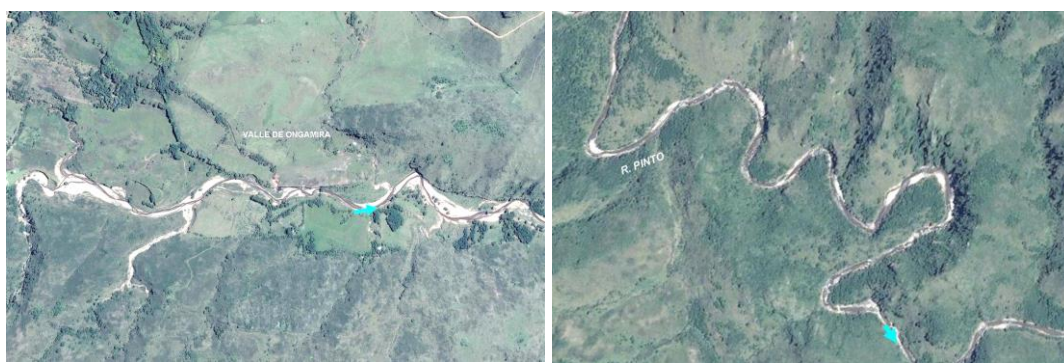
Figura 38. Izq. Erosión de márgenes en curvas externas y ampliación de canal .Der. Control por basamento.
