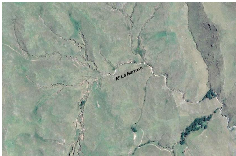
Figura 39. Erosión hídrica concentrada en cárcavas en nacientes del Aº La Barrosa.
