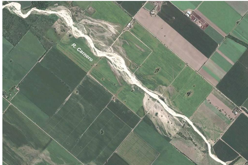
Figura 59. Desbordes laterales Río Carnero, colmatación de predios rurales.
