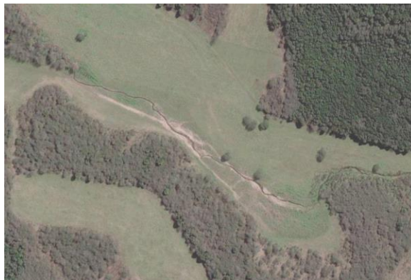
Figura 47. Erosión hídrica acelerada concentrada en cárcavas sobre los ejes de avenamiento de valles plano-cóncavos.
