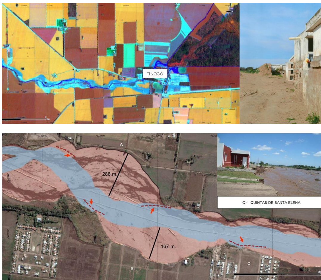
Figura 30. Arriba: afectación de la población de Tinoco por inundaciones. Abajo: Bº Santa Elena Jesús María. Ampliación del lecho ordinario por erosión de márgenes. Inundación Año 2015.
