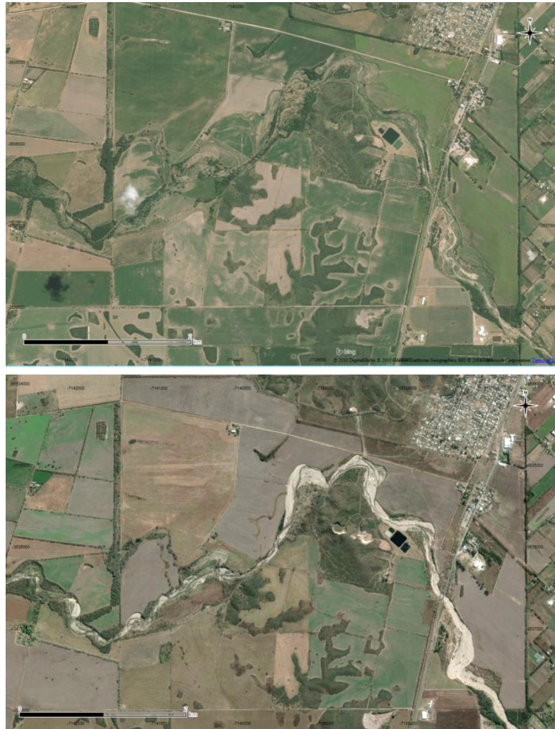
Figura 56. Arriba imagen Bing (2010) Abajo Imagen Google (2016). Ampliación de Cauce Río Carnero luego de la creciente del año 2015. RN9
